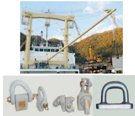
図30 デリック装置及び関連部位の例
