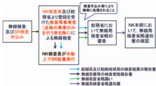
図29 定期的検査における検査フローの例 (本船上でSR証書が交付される場合)
