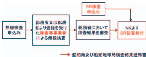
図28 登録検査における検査フローの例
