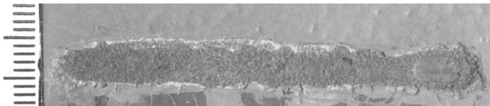
図 C-6 ウェーブタンク試験の側面試験片におけるスクライブからのさび幅 (冷却あり) (このモデル報告書の結果例は写真例と関係ない)
