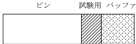
図 L3.5 延長したピンの試験片採取位置
