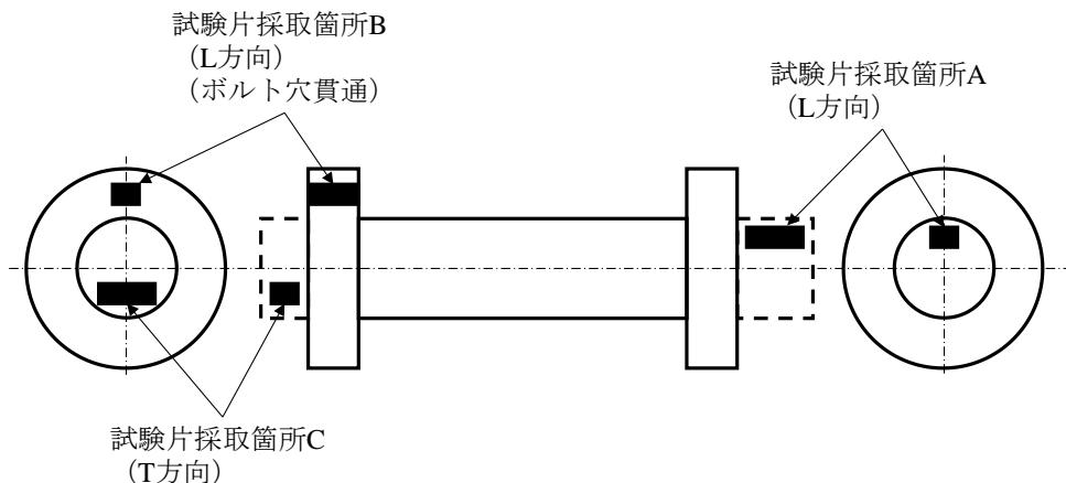
図 K6.4 フランジ及びカラー付き軸の代替試験片採取方法
