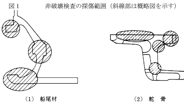
図2 超音波探傷検査の適用例
