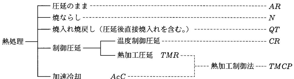
図 K3.1.4-2. 热処理プロセス
