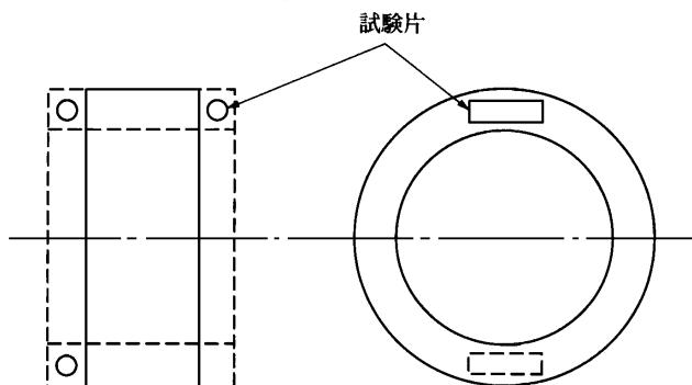
図 K6.11 大歯車の試験片採取方法
