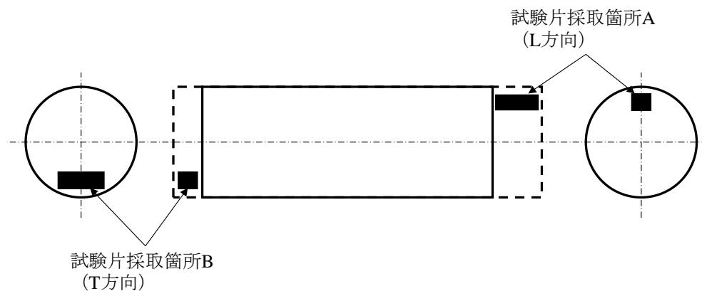
図 K6.3 フランジ付き軸の代替試験片採取方法
