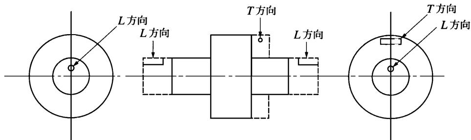
図 K6.6 タービンディスクからの試験片の採取方法
