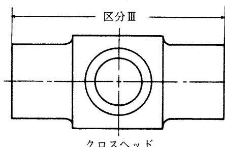
図 6 舵頭材及びピントルの探傷範囲及び区分
