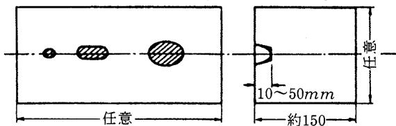
図3 供試材の寸法及び形状
