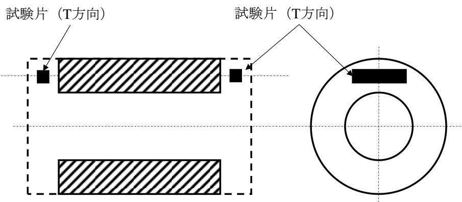
図 K6.10 歯車リムの試験片採取方法
