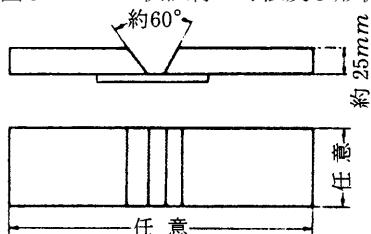
図4 試験片の採取位置
