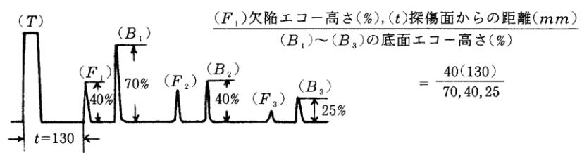
図 13 探傷結果（単独欠陥エコー）
