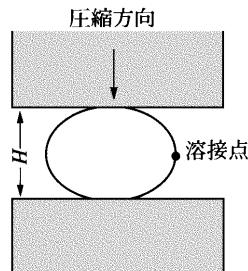
図 K4.2 C形試験片のへん平試験
