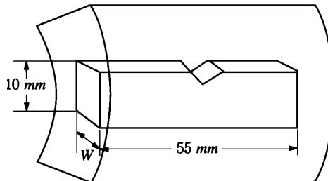
図 K4.4 電気抵抗溶接鋼管の溶接部からの衝撃試験片の採取位置
