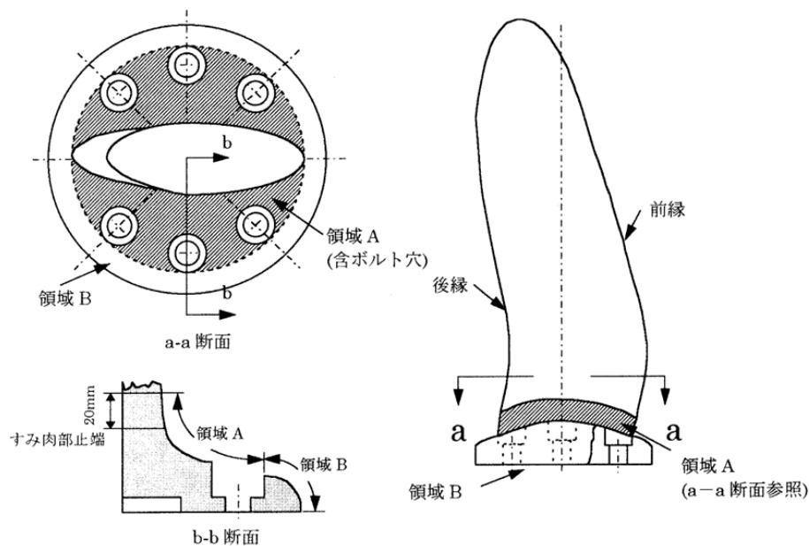
(b) 可変ピッチプロペラあるいは組立型プロペラの翼根元部
