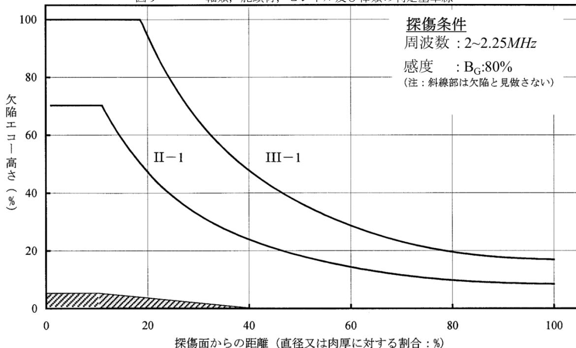
図 10 ターピンロータ軸の判定基準線図
