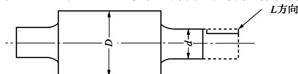
図 K6.8 径が 200mm を超える小歯車の試験片の採取方法
