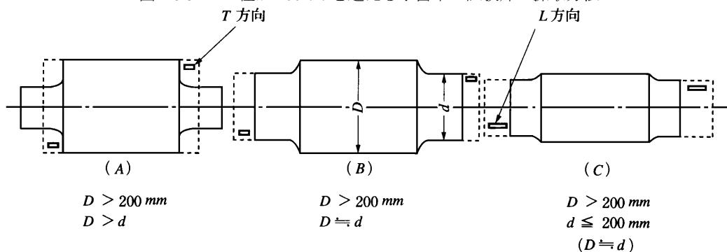
図 K6.9 歯車筒の試験片採取方法
