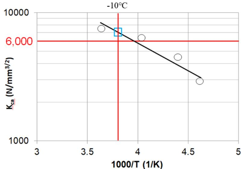
図 2 要求される  $K_{ca}$  に対する温度の評価例
