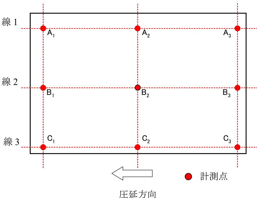
図 K3.1.8-2. 圧延後に鋼材を切断する場合の厚さの測定箇所の例
