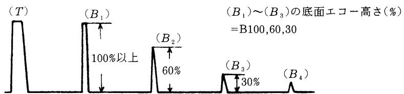
図 12 探傷結果（欠陥部）
