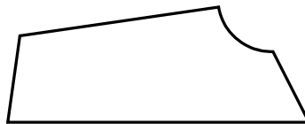
図 D.5.5 不規則な形状を有する非防撓パネルのモデル化
