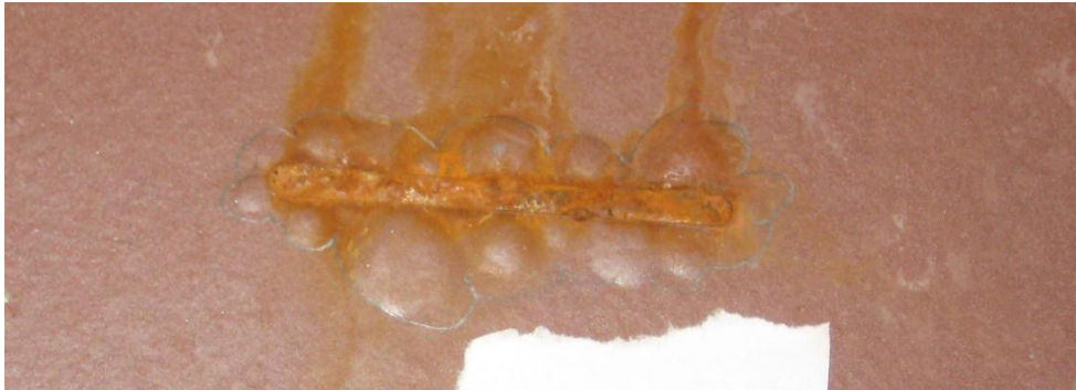
図 C-3 粘着性のない塗装を剥がす前のウェーブタンク試験の天井試験片におけるスクライプ範囲(このモデル報告書の結果例は写真例と関係ない)
