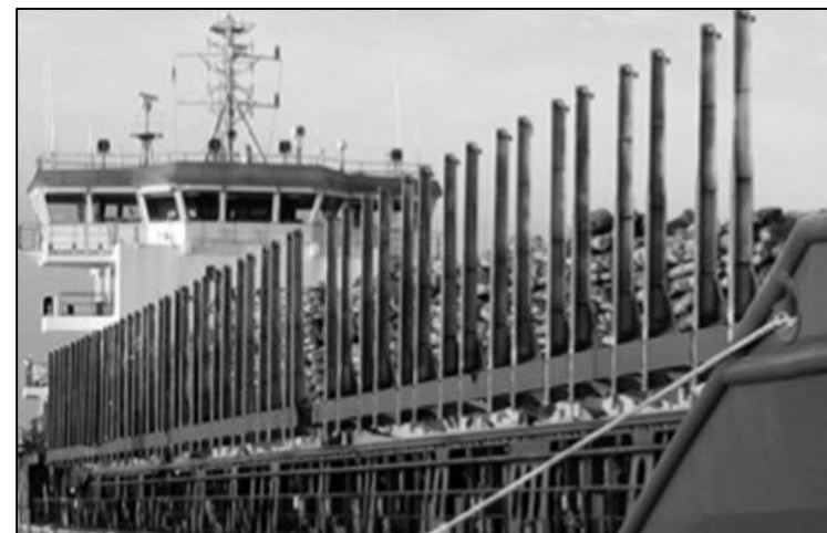
木材運搬船 のスタンション (出典:IMO A.1048(27))
