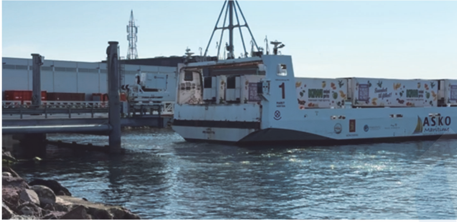
図1 ASKO Maritの自動着栈の様子（後進接岸）
