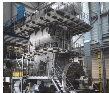
図8 WinGDの低速2ストローク単気筒 テストエンジン（シリンダ径：520mm） （WinGD社提供）
