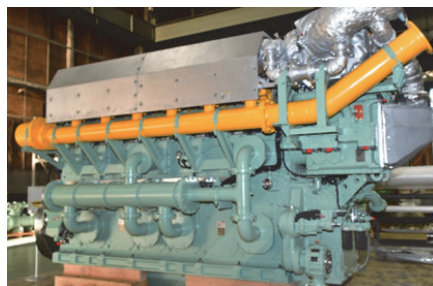
図10 A-Tug用中速4ストローク28ADF型エンジン （出力：1618kW/台・D/S：280/390mm・6気筒・ 回転数：750rpm・Pme：1.8MPa） 18)
