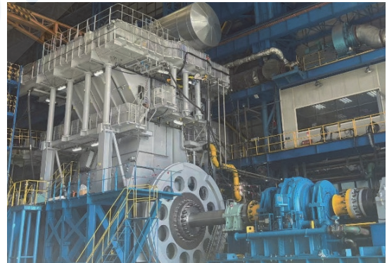
図2 WinGDの低速2ストローク・メタノールエンジン開発のための単気筒テストエンジン SCE920（シリンダ径：920mm）（WinGD社提供）
