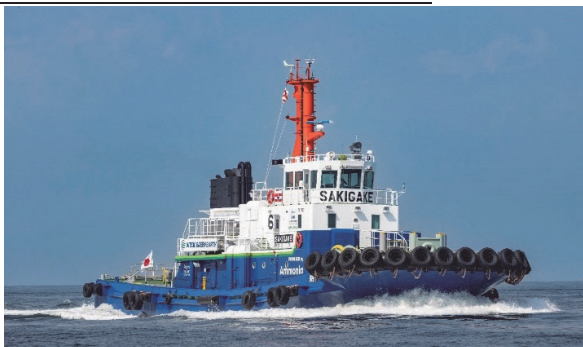
図9 A-Tug さきがけ（主機出力1618kW x 2台） 19)
