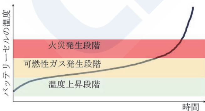
図4 リチウムイオンセルの熱暴走に至るまでの事象の整理
