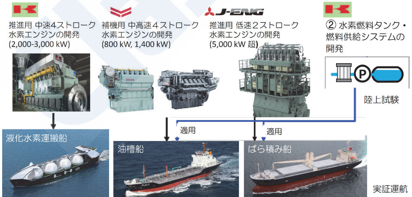
図10 船用水素エンジン及びMHFS (Marine Hydrogen Fuel System) の開発 (NEDO HP)
