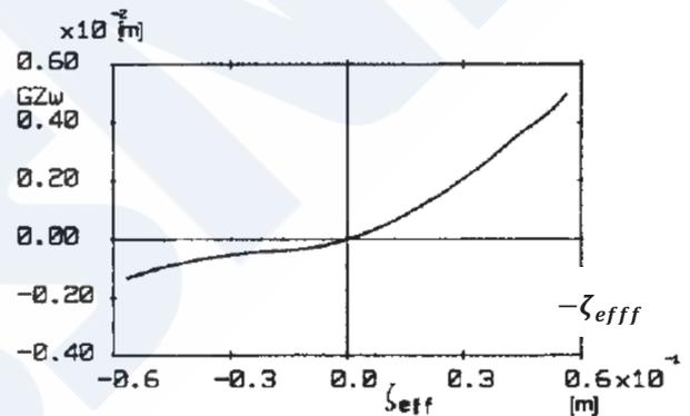
図1 小型底曳網漁船における波長船長比1の縦波で船体中央に波の山 ( $-z_{eff}$ 負) または谷 ( $-z_{eff}$ 正) があるときの横傾斜角10度でのGZの平水中からの変化の値<sup>15)</sup>
