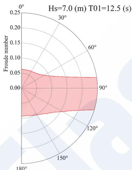
図5 パラメトリック横揺れに対する簡易操船ガイドンス案の適用例（有義波高7m，平均波周期12.5秒）
