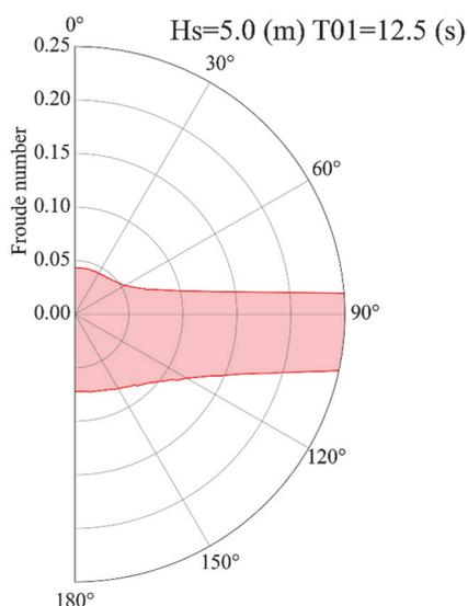
図4 パラメトリック横揺れに対する簡易操船ガイドンス案の適用例（有義波高5m，平均波周期12.5秒）
