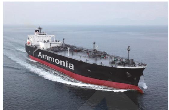
図2 アンモニア燃料塔アンモニア輸送船
