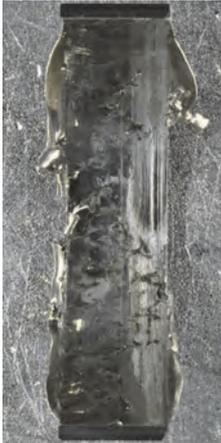
図8 模擬試験後の軸受メタル表面
