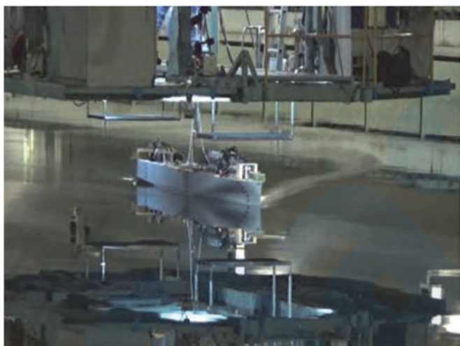
図5 離着岸操船システム 模型実験
