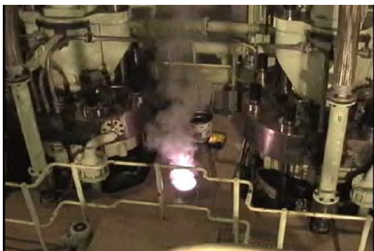
主機上部シリンダ間における模擬火災
