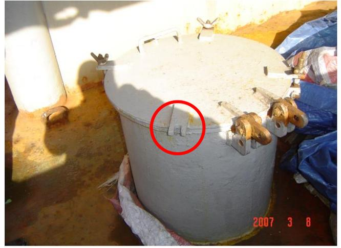
小倉口蓋締め付けナット及び締め付け装置の欠落
