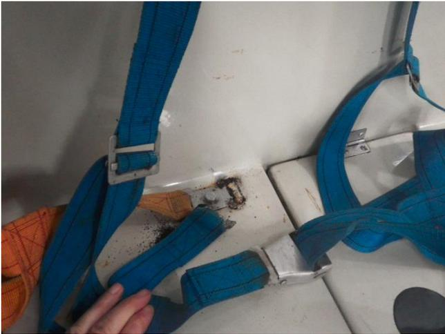
著しく損傷した安全ベルト
