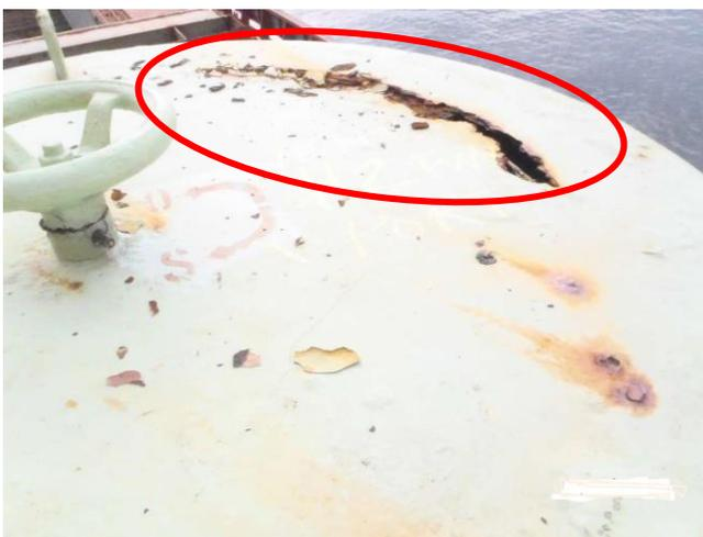
腐食衰耗により破孔した通風筒カバー
