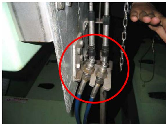
ブラケットの曲損にともなうケーブルの損傷
