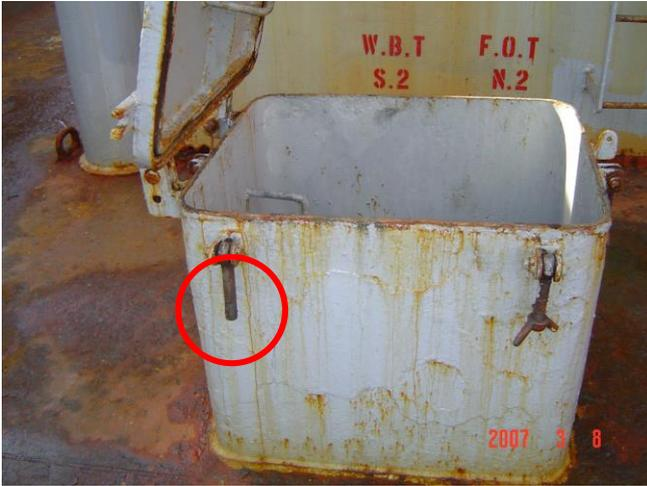
小倉口蓋締め付けナットの欠落
