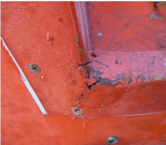
著しく損傷したライフボート船殻
