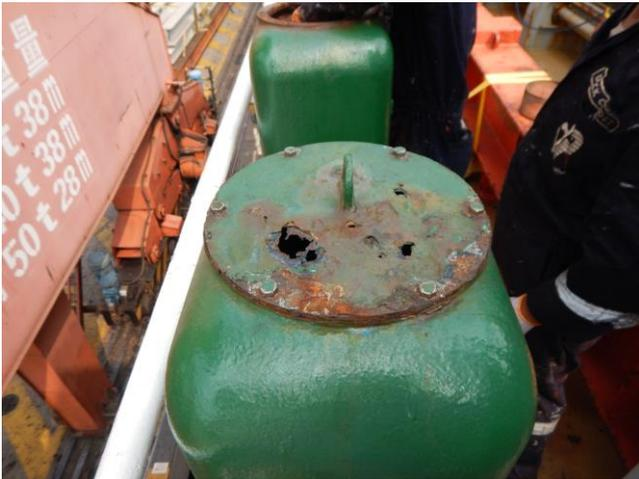
腐食衰耗により破孔した空気管頭
