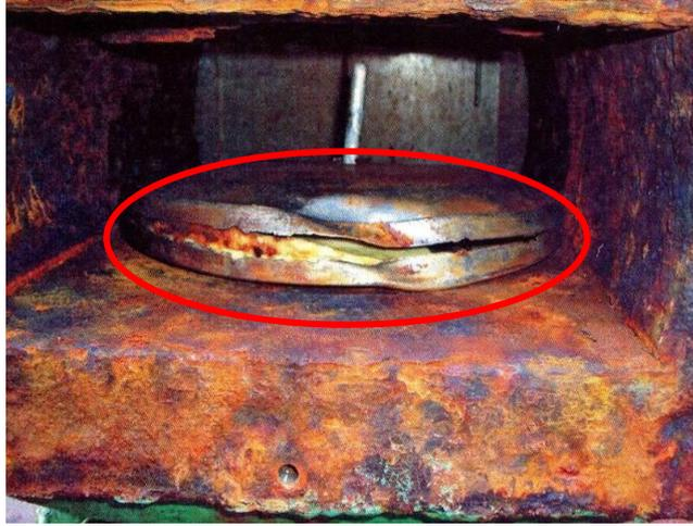
著しく損傷したディスクフロート
