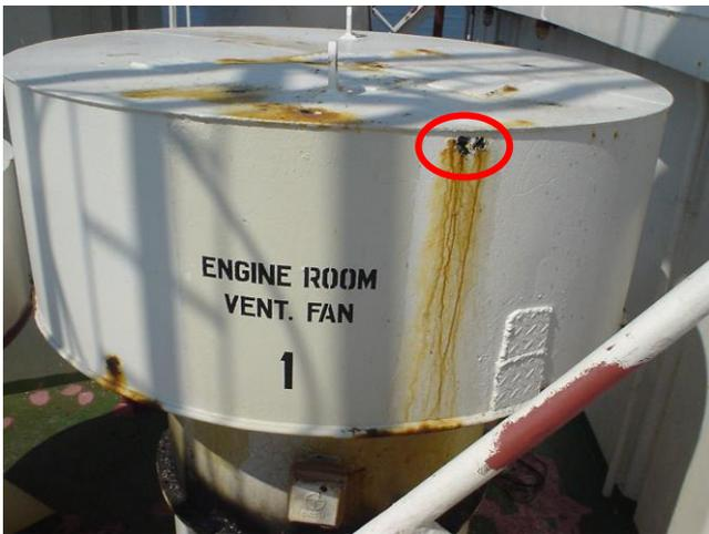
腐食衰耗により破孔した通風筒カバー
