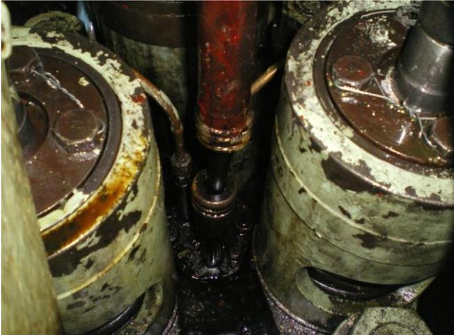
二重化が要求される高圧燃料油管の部分的なジャケットの欠落
