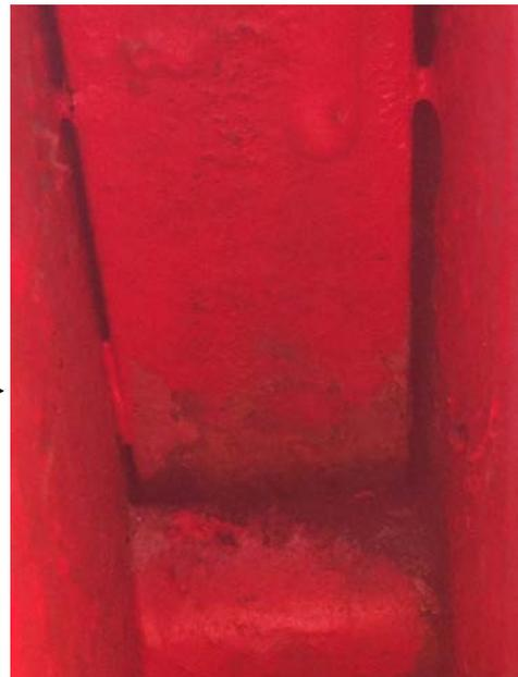
過度なペイントにより固着した状態の負荷離脱装置
