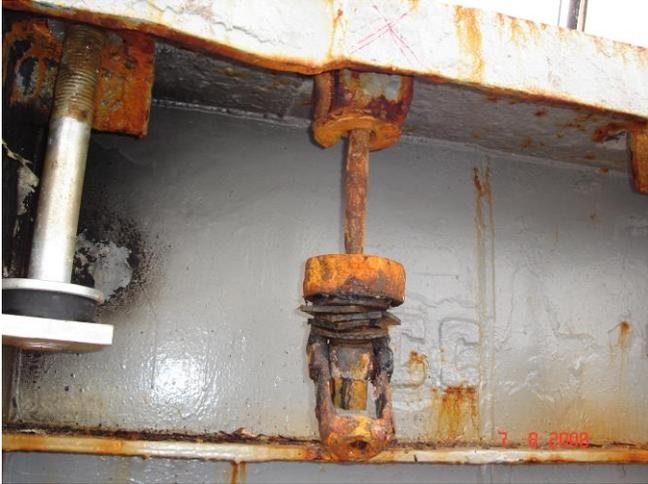
腐食衰耗した貨物倉口蓋用締め付け装置
