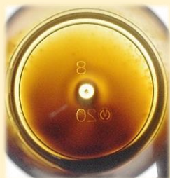
写真1 VLSFOの混合安定性に問題のない場合 (スラッジが発生しない)
