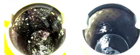
図6. テストエンジンストレーナー状態 左: ExtRS未添加 右: ExtRS 10%添加
