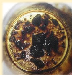
写真2 VLSFOの混合安定性に問題がある場合 (凝集したスラッジが生成して底部に堆積)
