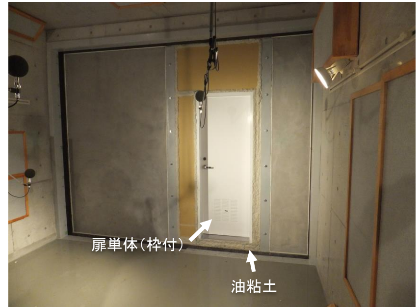
扉単体試験体 試験室内設置状況
