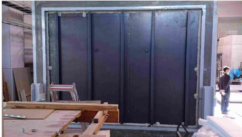
試験体 カートリッジ取付状況
