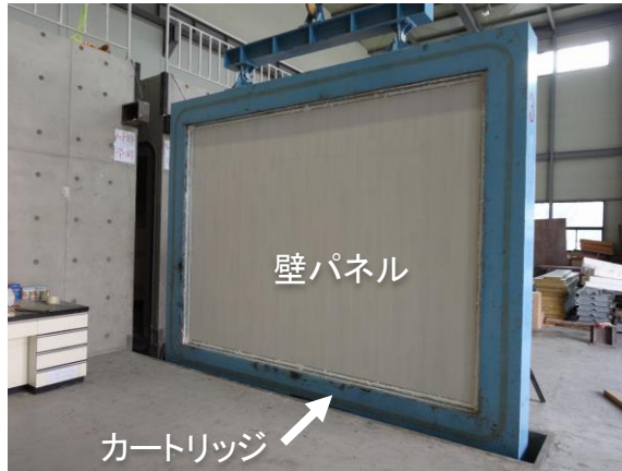
試験体カートリッジ取付状況
