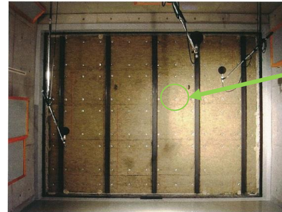
試験室内設置状況 (ロックウール側)
