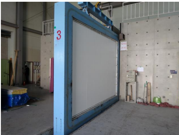
試験体 カートリッジ取付状況（パネル側）
