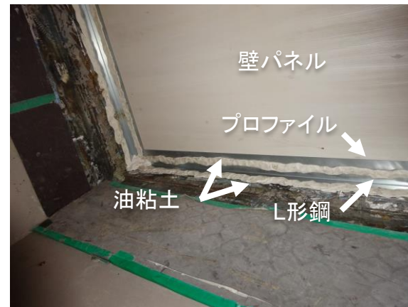
試験体 隙間処理状況
