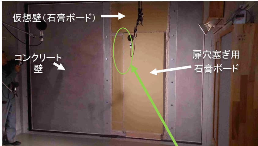
仮想壁遮音試験
