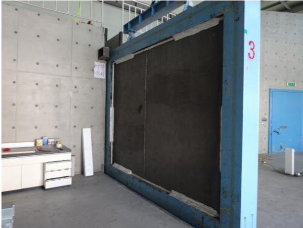
試験体 カートリッジ取付状況（鋼板側）
