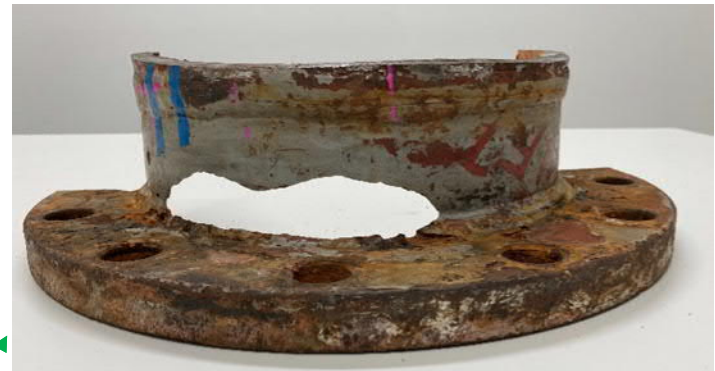
船体付きディスタンスピース に発生した腐食損傷例
