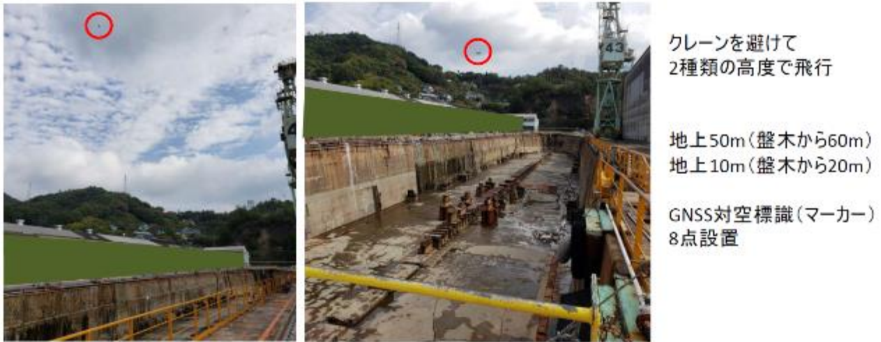
図7 ドローン飛行の様子(ドック上空)
