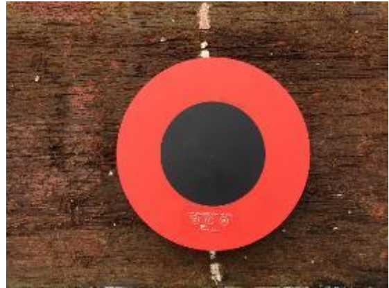
図2 ドック内のマーカー（盤木上に配置）
