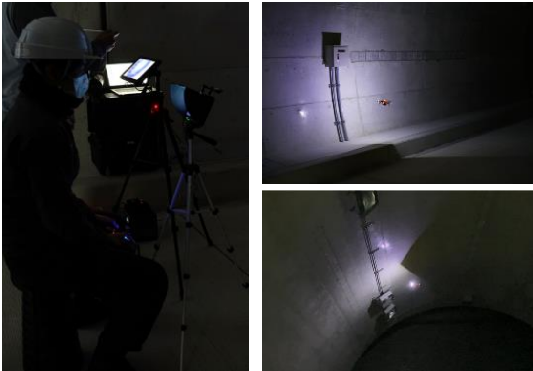
図5 IBIS のフライトの様子（左：オペレータ、右上：トンネル側面、右下：側面上部）
