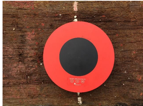
図 5 ドック内のマーカー (盤木上に配置)
