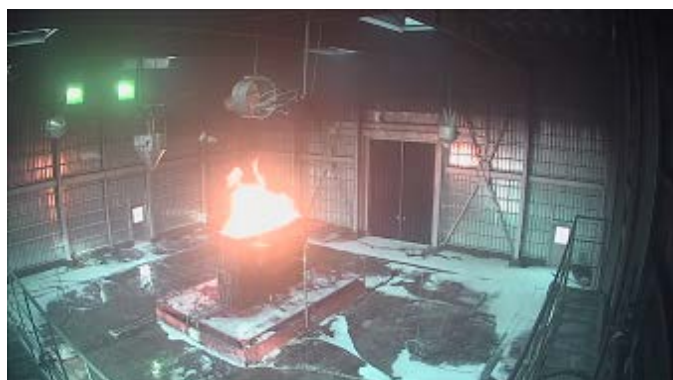
図 3.1.2 ディーゼルエンジン火災の高膨張泡による消火 (インサイドエア方式発泡器)
