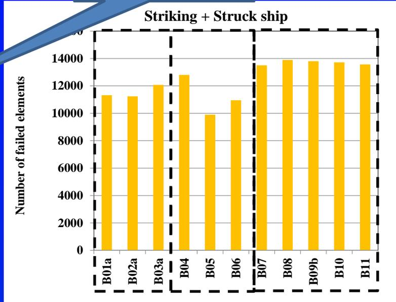
被衝突船の破壊用素数はFull→Partial II→Conv.の順に増加し、衝突船のそれはその順に従って減少する。両船の和ではFullおよびPartial IIで少なくなっている。
