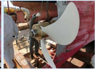
2ブレードを差し込み後、ボスを180度回転させて残りのブレードを差し込む
