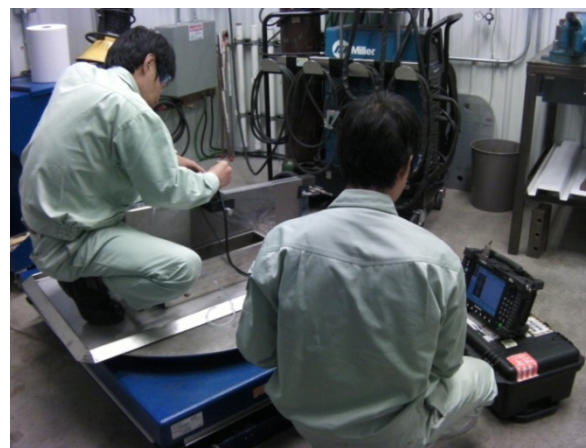
非破壊検査状況
