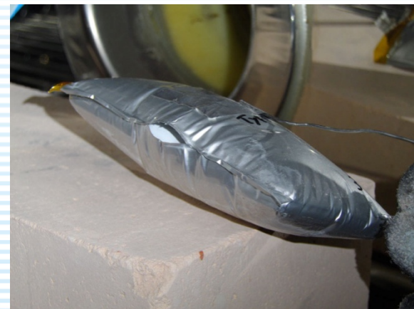
加熱試験中に破けた電池セル
