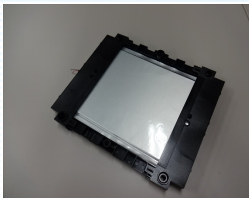
高電圧モジュール用 ラミネート固定用セルパック
