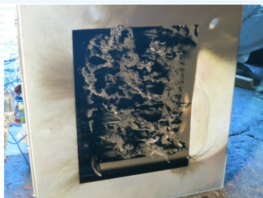
モジュール底面(通風のため開口) セルパックが溶けている
