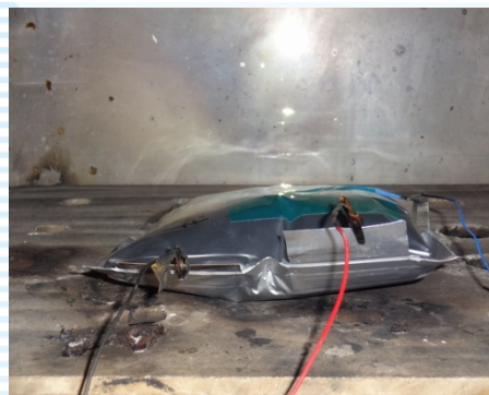
写真. 130℃保存試験のセルの状況
