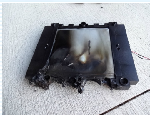
溶けたセルパック セル下部が開封している
