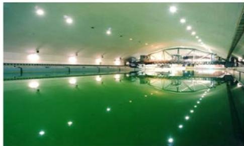
実験水槽: 耐航性能水槽
