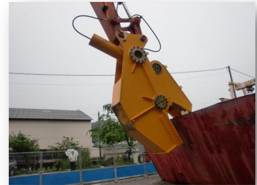
図2.5 ボックスカッター一切断状態
