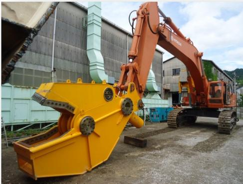
図2.3 ボックスカッター取付状態
