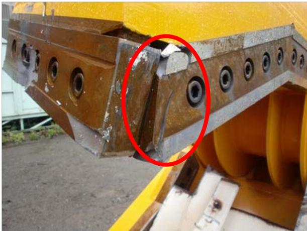
①切断刃物の破損・亀裂
