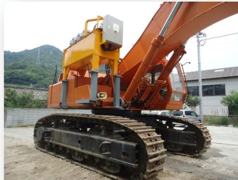
図2.4 油圧ユニット設置状態
