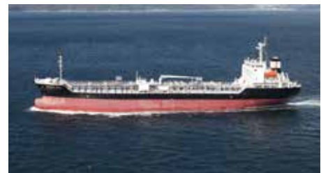
Buque químico aplica acero dúplex en su tanque de carga M/V "SUNRISE HOPE" 7,247gt CHEMICAL CARRIER construido por USUKI SHIPYARD CO., LTD. para HIRO NAVIERA S.A.
