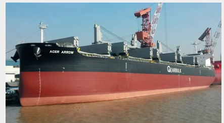
السفينة ACER ARROW تم بناء ناقله شحن بضائع عامة تبلغ حمولتها الإجمالية ٣٥٥٠٢ طن من قبل شركة NANTONG COSCO KHI SHIP ENGINEERING CO., LTD. لصالح شركة MMSL PTE LTD.
