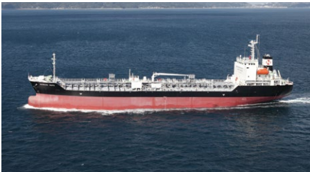
ناقلة مواد كيميائية تقوم بتطبيق الفولاذ المزدوج في خزان البضاعة الخاص بها "M / V SUNRISE HOPE" تم بناء ناقلة مواد كيميائية تبلغ حمولتها الإجمالية ٧٢٤٧ طن من قبل شركة HIRO NAVIERA S.A. لصالح شركة USUKI SHIPYARD CO., LTD.
