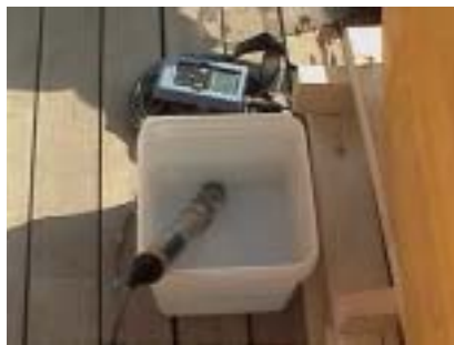
写真 3.8-1 水質メータによる水温、塩分、pH、DO、NTU の測定
