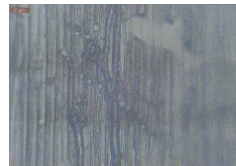
シリンダライナに埋没した Cat-finesとアブレイブ摩耗の跡
