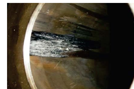
燃料噴射ポンプのプランジャー・バレルでの掻き傷
