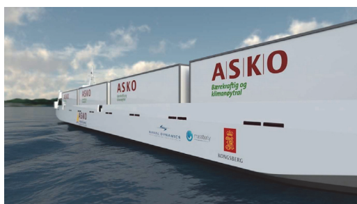
自律運航型電気推進フェリー (船長67m, 1,846 kWhバッテリー搭載)
