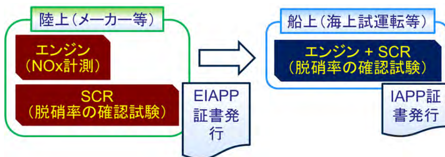
図5 スキームBによるSCR付機関の認証
