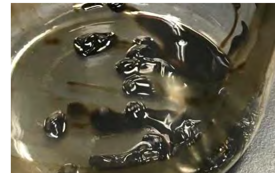
金属容器に採取したワックス (出典: 2020年SOx規制適合船用燃料油 使用手引書(国土交通省 海事局))
