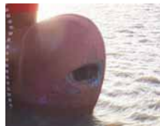
船首部の損傷
