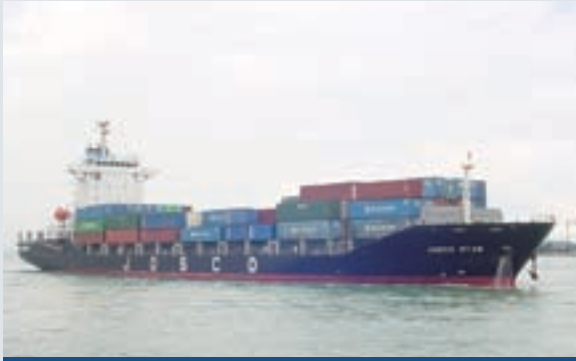
JOSCO STAR호 대선조선이 건조하여 Jiangsu Ocean Shipping사에 인도한 12,820 dwt급 컨테이너 운반선
