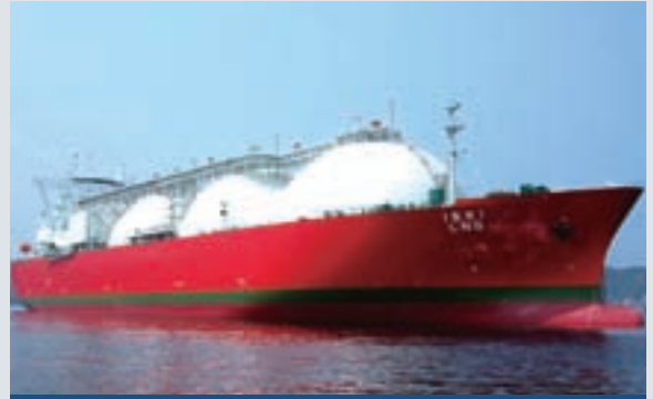
IBRI LNG호 미츠비시중공업의 나가사키 조선소에서 건조하여 Oman Ship Management Company S.A.O.C.에 인도한 77,282 dwt급 LNG 운반선
