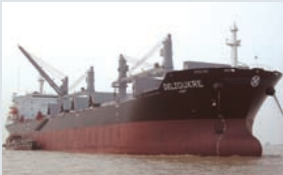
DELZOUKRE호 Yangzhou Dayang Shipbuilding 사가 건조하여 Meadway Shipping & Trading사에 인도된 53,630 dwt급 벌크선
