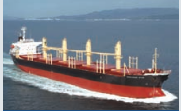
SHIMANAMI STAR호 시마나미 조선소 (Shimanami Shipyard)가 건조하여 Evalend Shipping사에 인도한 28,447 dwt급 벌크/원목 운반선
