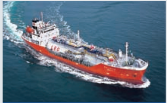
OBELIX호 히가키조선이(탱크제조자: 이즈미강업) 건조하여 고베 선박 회사에 인도한 1,290 dwt(1,520 m³)급 액화 가스 운반선 (PRESS/LOW-T)
