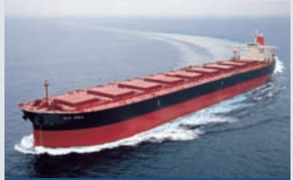
SEA PULL호 미츠이조선이 치바 조선소에서 건조하여 하시모토기선에 인도한 177,533 dwt 크기의 벌크 운반선
