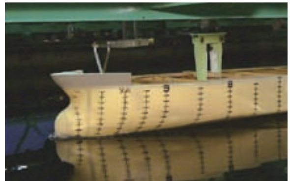
발라스트 탱크가 없는 수에즈맥스급 NOBS형 유조선의 수조 검사 모습
