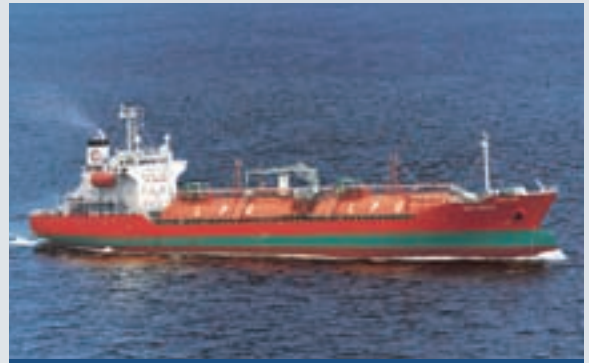
GAS DREAM호 시타노에조선 (Shitanoe Shipbuilding)이 건조하여 KSS Line사에 인도된 5,352 dwt급의 고압 LPG 운반선
