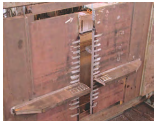
Thử nghiệm hiện tượng nứt giòn với quy mô lớn
