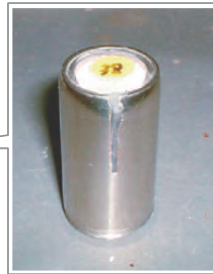
Các đầu RFID chịu nhiệt của Toppan Printing Co., Ltd. và Nippon Sheet Glass Co., Ltd
