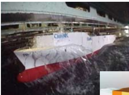
Parte superior: Prueba del canal hidrodinámico para obtener la respuesta de buques portacontenedores grandes a la trepidación
