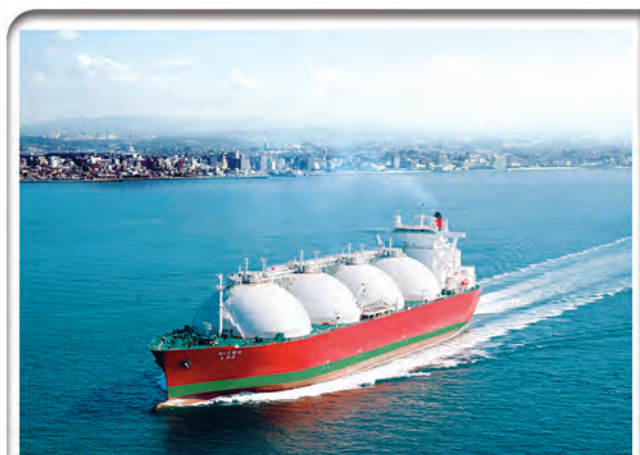
NIZWA LNG号 由Kawasaki造船株式会社为Oryx LNG Carrier公司建造的 145,469m 3 (-163℃, 98.5%舱容时)液化天然气船
