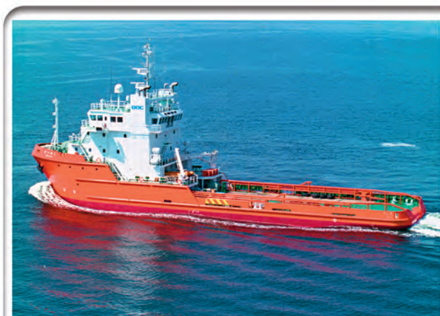
KAIYU号 由ISB株式会在2005年3月为Offshore Operation公司 建造的1,703吨拖船/工作船，将于2006年3月中旬 安装拖带/起抛锚绞车、夹具/带缆销和动力定位系统
