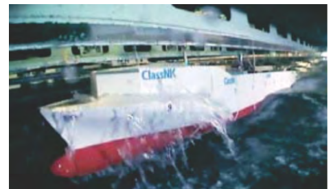
Thử kết ở vị trí kéo đẩy về phản ứng của tàu container lớn khi chạy với tốc độ cao
