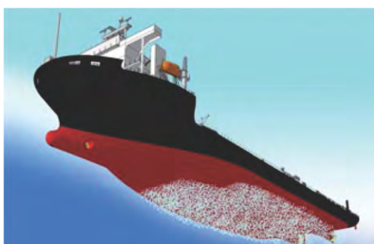
Hệ thống bọt trơn bằng khí làm giảm ma sát giữa đáy tàu và nước biển
