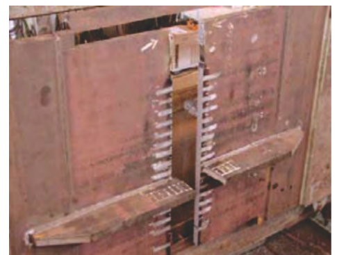
Thử nghiệm hiện tượng nứt giòn với quy mô lớn
