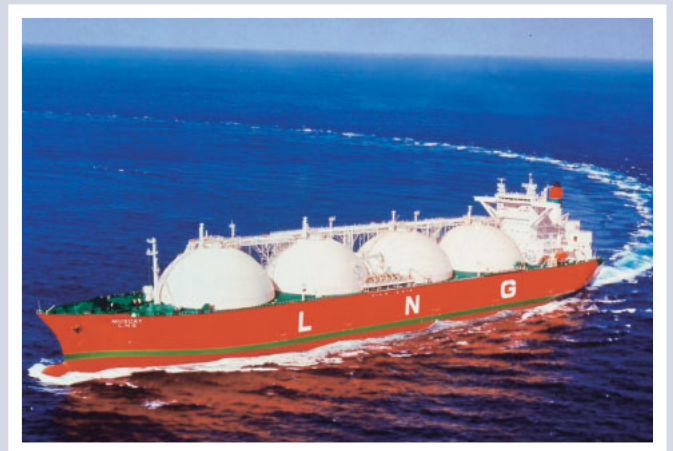
MUSCAT LNG A 145,464m 3 (at -163°C, 98.5% tank capacity) LNG Carrier built by Kawasaki Shipbuilding Corporation for Oasis LNG Carrier S.A.
