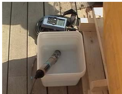
写真Ⅱ.3.8-1 水質メータによる水温、塩分、pH、DO、NTU の測定
