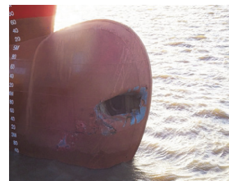
船首部の損傷
