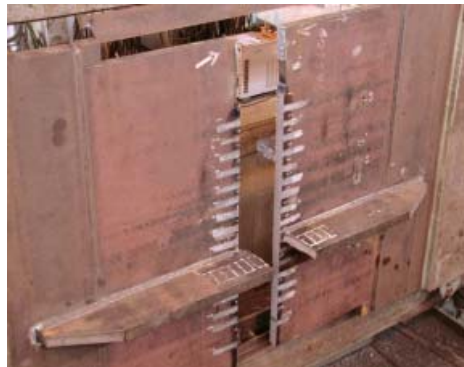
إجراء قياس اختبارات الكسر والتقصف على نطاق واسع
