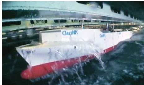
قطر خزان لاختبار أثر الصدمات على سفن الحاويات الضخمة
