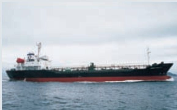
JANESIA ASPHALT IV Kurinouura造船公司为Nissho Odyssey公司建造的4,317 dwt沥青船
