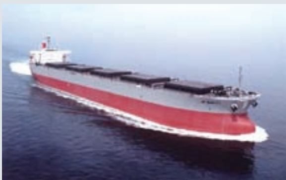
JP GUNJO 今治造船公司Marugame总部为长崎Kisen Kaisha 承建的88,172 dwt散货船
