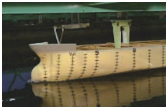
在无压载水条件下的苏伊士型油船NOBS设计试验
