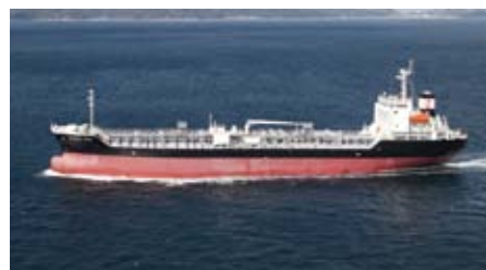
カーゴタンクに二相ステンレス鋼を適用したケミカルタンカー M/V "SUNRISE HOPE" 7,247gt CHEMICAL CARRIER built by USUKI SHIPYARD CO., LTD. for HIRO NAVIERA S.A.
