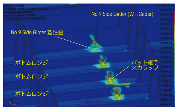
3ホールドモデル弾塑性結果（例4）（最終強度状態の二重底内歪）（例3と対）
