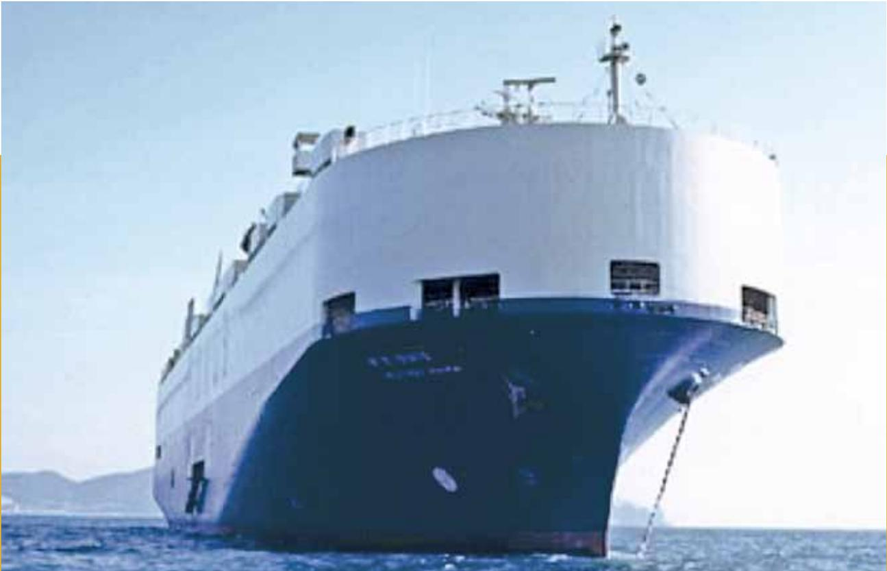
dem spezifischen Konstruktionsproblem von PCCs, durchgeführt. Zu PCCs verschiedenster Größen wurden Berechnungen zu Fahreigenschaften und Seegang durchgeführt und die für die Wandfestigkeit entscheidenden Belastungsszenarien durch Seegang ermittelt. Auf Basis dieser Untersuchungen wurden
